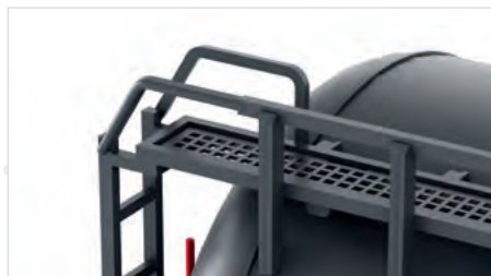
Durchbrochen dargestellte Laufgitter aus Ätzblech
