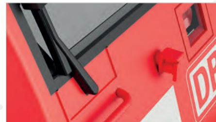
Freistehende Griffstangen und UIC-Dosen an der Lokfront
