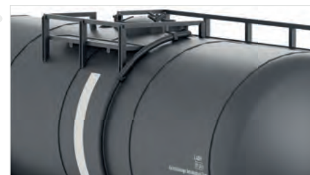
Extra angesetzte Leitung für Chemiekessel
