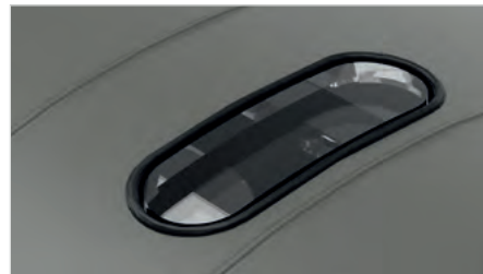
Nachbildung der Dachfenster am Maschinenraumdach
