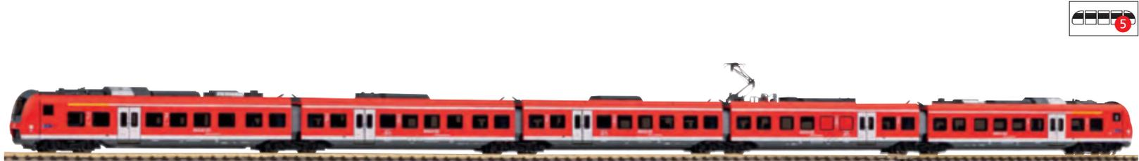
40275 5tlg. Elektrotriebwagen BR 440 Coradia Donau-Isar DB AG Ep. VI
