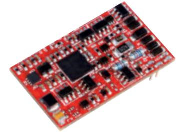
Nach dem Motto Plug & Play unterstützt der PSD XP alle gängigen Datenformate wie DCC mit RailComPlus®, mfx® (nicht bei Next18), Motorola.
