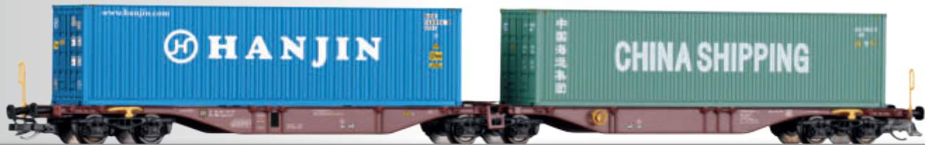
Containertragwagen Sgmrss der SNCB, beladen mit zwei 40'-Containern Container car Sgmrss of the SNCB with load
