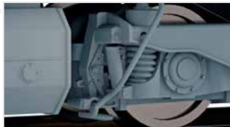
Aufwendige Nachbildung der Bremsanlage sowie Sandfallrohre
