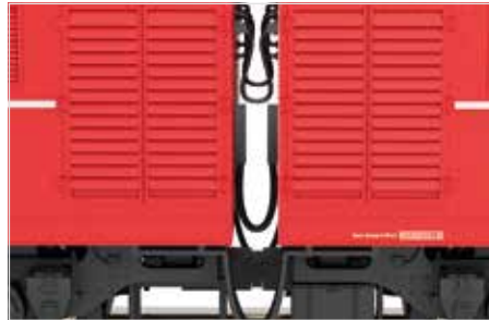
Detaillierte Nachbildung aller Verbindungsleitungen zwischen den Lokhälften
