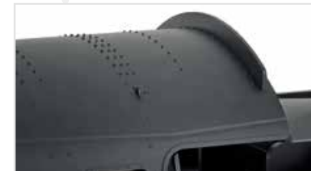
Dach mit Windabweiser, Regenrinnen in klassischer DR-Ausführung
